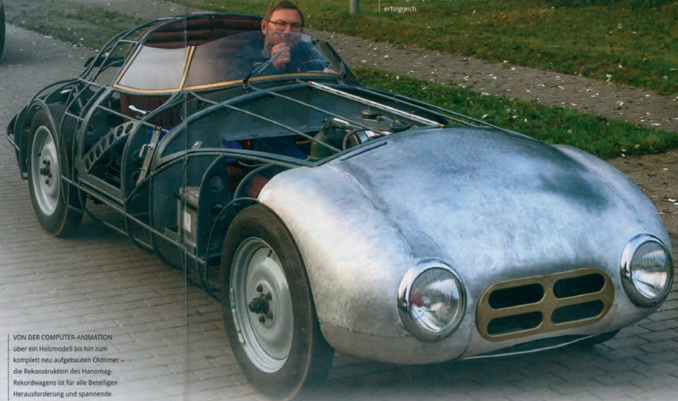
ALS BASIS FÜR DEN WIEDERAUFBAU kaufte die Hanomag-Interessengemeinschaft ein altes Serienfahrzeuggestell. Die Wiederinbetriebnahme eines 1,9-Liter-Dieselmotors verlief nicht immer ganz qualmfrei, aber letztlich erfolgreich.
